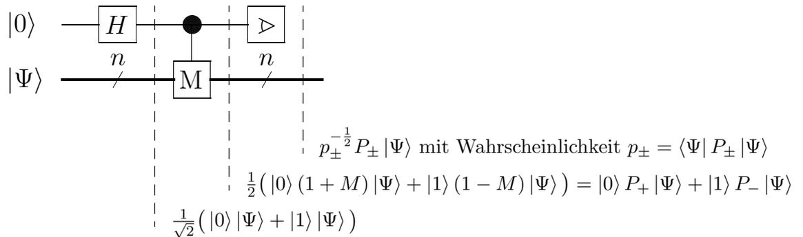
Die Rechnung zeigt, dass dieses Schaltbild äquivalent ist zur formalen Messung der Observablen  $M$ . Dies ist auch der Grund, warum gewöhnlich keine Quantenschaltelemente für die Messung spezieller Matrizen benutzt werden: Dieses Problem läßt sich auf die Messung einzelner QuBits in der kanonischen Basis zurückführen.
